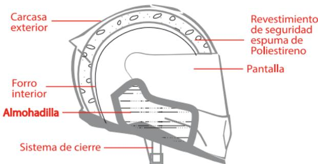
La principal función del casco es la de proteger la cabeza en caso de impacto. Esto es posible gracias a las características mecánicas de los varios tipos de materiales y diferentes densidades de su revestimiento de seguridad de poliestireno expandido.
