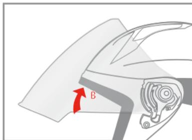
**A) Tirez vers l'extérieur pour retirer l' écran pare-soleil du mécanisme.**
