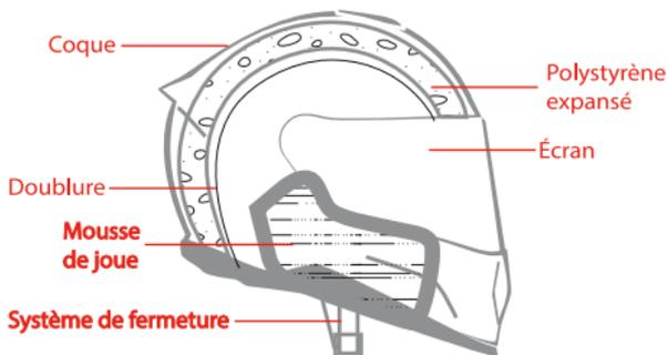
La principale fonction d'un casque est de protéger votre tête en cas de choc. Cela est réalisable grâce à la capacité d'absorption de différents matériaux et de Polystyrène de différentes densités qui amortit les chocs.
