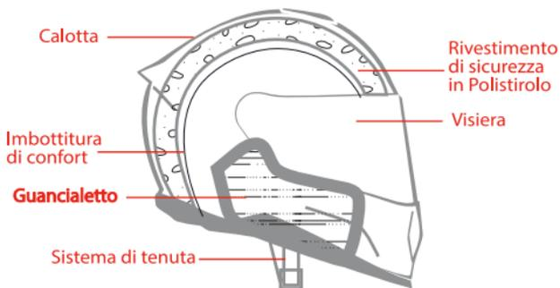
La principale funzione di un casco è quella di proteggere la testa in caso di impatto causato da un incidente, questo è possibile grazie alle caratteristiche meccaniche dei diversi tipi di materiali usati e alle diverse densità del rivestimento di sicurezza in polistirolo.
